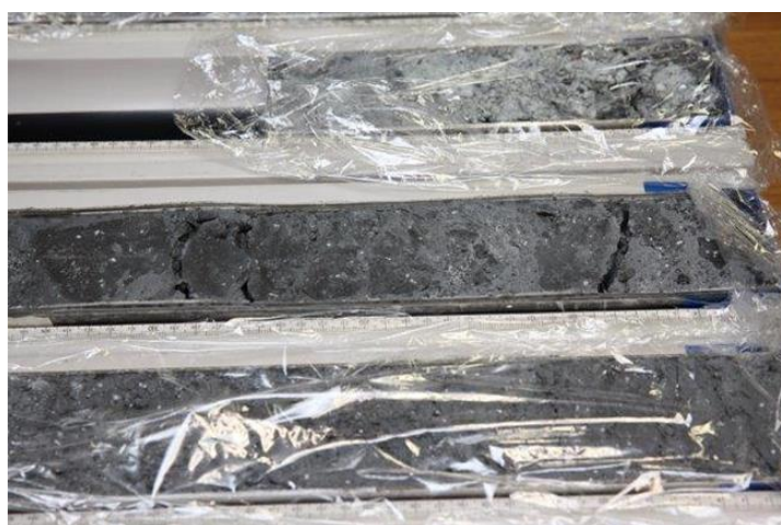
图 3 采集到的海底地层下热液矿床母体的硫化物富含层（一部分）
